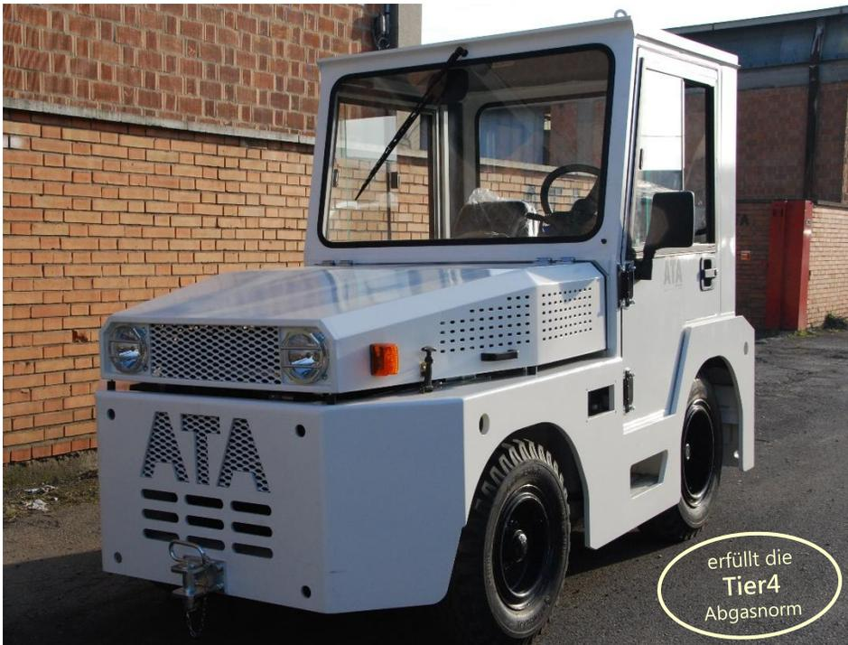
Der ATA 5000 ist die universelle Zugmaschine zum Ziehen von Anhängern **bis 50t**. Er wurde standardmäßig mit einem neuen **Perkins Dieselmotor** ausgerüstet, der bereits die Abgasnorm Tier4 erfüllt. Alternativ ist auch ein Antrieb mit **Flüssig-Gas (LPG)** möglich. Das hohe Drehmoment des Motors wird mit einem hydrodynamischen Powershift Getriebe umgesetzt, um ein Optimum an Zugkraft und Langlebigkeit auch bei harten, täglichen Einsatz zu gewährleisten.
