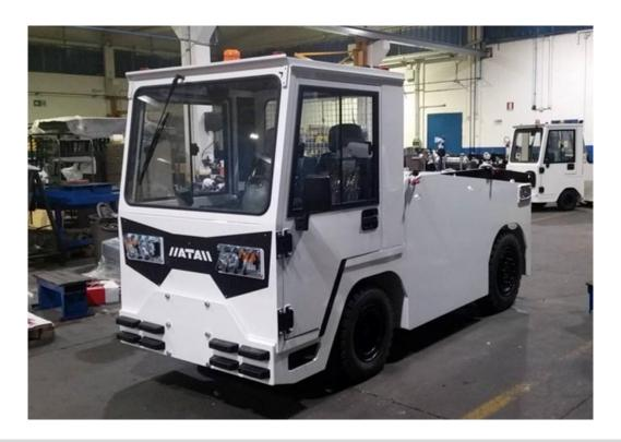
Der neu konzipierte Elektroschlepper **ATA E605** ist für Schlepplasten bis maximal **70 Tonnen** in der Ebene ausgelegt. Er ist serienmäßig mit einem programmierbaren **Drehstromantrieb** ausgerüstet, welcher die Vorteile Zuverlässigkeit, geringer Wartungsaufwand, größere Leistungsfähigkeit und feinfühligerem Rangieren miteinander vereint.
