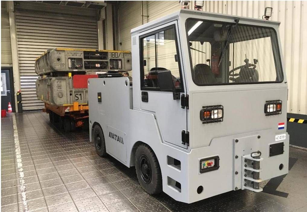
Der neu konzipierte Elektroschlepper E800 ist für Schlepplasten bis maximal **80 Tonnen** in der Ebene ausgelegt. Er ist serienmäßig mit einem **Allradantrieb 4x4** und einer **2-Achs-Lenkung** ausgestattet, die unerreichte Wendigkeit in dieser Fahrzeugklasse ermöglicht. Ein programmierbarer **AC-Drehstromantrieb** und **Lamellenbremsen** bedeuten geringen Wartungsaufwand, größere Leistungsfähigkeit und feinfühleres Rangieren.
